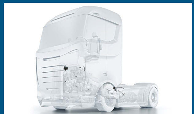
Abgassensoren von Bosch im Nfz: Abgas-Temperatursensoren, Differenzdrucksensoren, Lambdasonden, Partikelsensoren, Stickoxidsensoren
