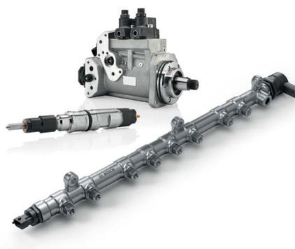
auf bis zu 2700 bar und stellt ihn in der erforderlichen Menge bereit. Dazu fördert sie permanent Kraftstoff in den **Hochdruckspeicher** (Rail) und hält den Systemdruck aufrecht. Die **Common-Rail-Injektoren** werden über kurze Leitungen aus dem Hochdruckspeicher versorgt und spritzen den Kraftstoff direkt in die Brennräume des Motors ein.
