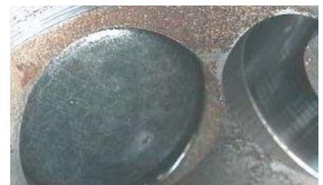
Korrosion am Hochdruckpumpengehäuse
