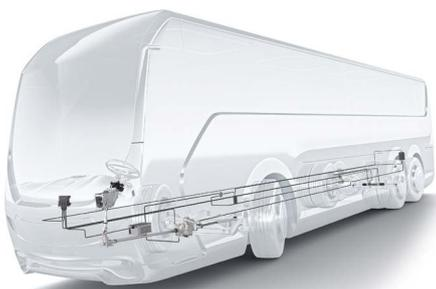
Nfz-Lenksystem mit Hinterachslenkung
