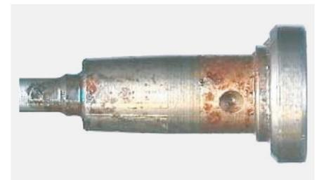
Korrosion am Injektor
