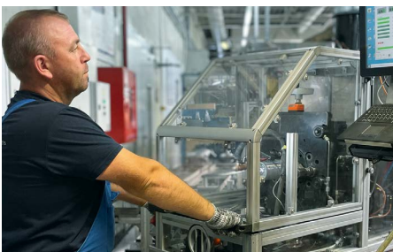
Leistungstest zur Prüfung von Funktionalität und Leistung nach Herstellervorgabe
