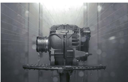
Spritzwassertest zur Prüfung der Dichtigkeit nach Schutzgraden IPX4, IPX4K und IPX9K
