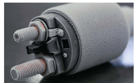
Kältelagerung, Wärmelagerung und Feuchtigkeitswechsel zum Nachweis der Klimastabilität
